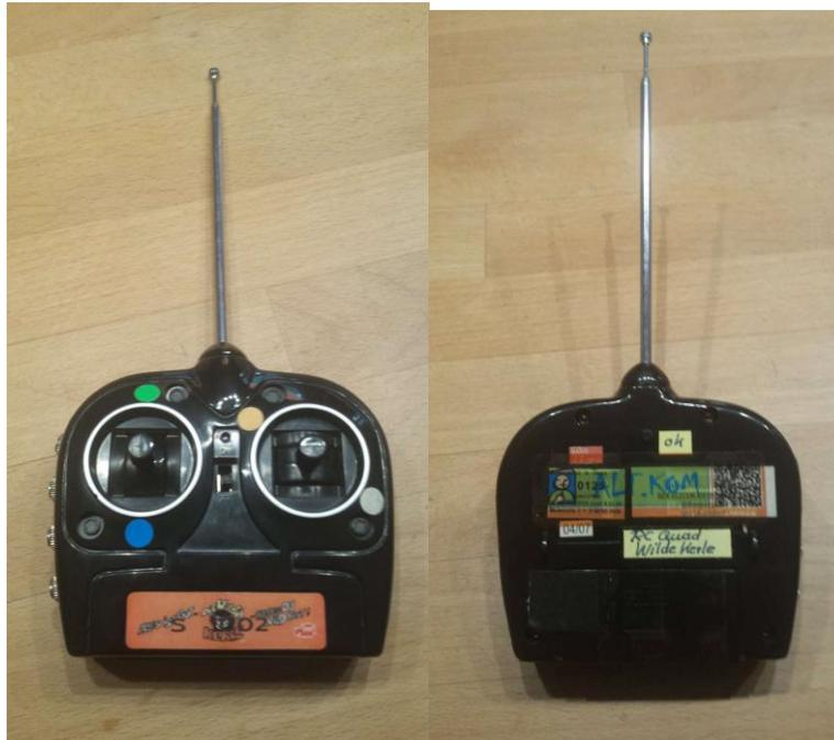
Die vier rückseitigen Schrauben - Kreuzschlitz – herausdrehen und das Gehäuse aufklappen.
