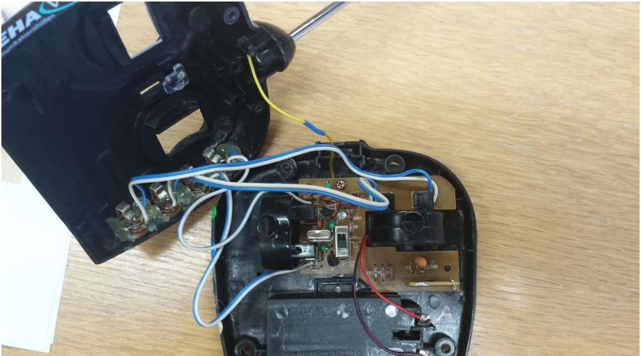
Die Kontakte werden nur abgegriffen und nach außen geführt.
